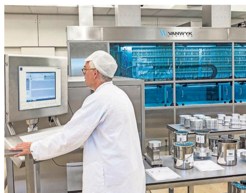
Marco Snel stelt de automatische doseerinstallatie in, die de juiste hoeveelheid grondstoffen voor een aroma mengt.
